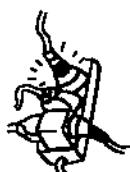
S klimatizační jednotkou nikdy nesmíte manipulovat mokrýma rukama. Mohlo by to vést k úrazu elektrickým proudem.
