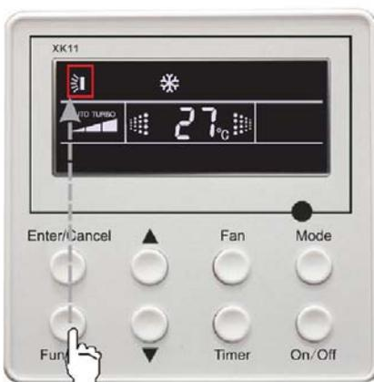
Mit der Taste „Function“ die Swing-Funktion auswählen
