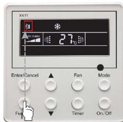
Mit der Taste „Function“ die Swing-Funktion auswählen
