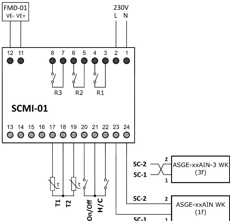
obr. 5. Řídící modul SCMI-01 v režimu přepínaného topení / chlazení
