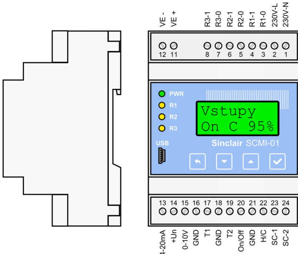
obr. 1. Řídící modul SCMI-01
