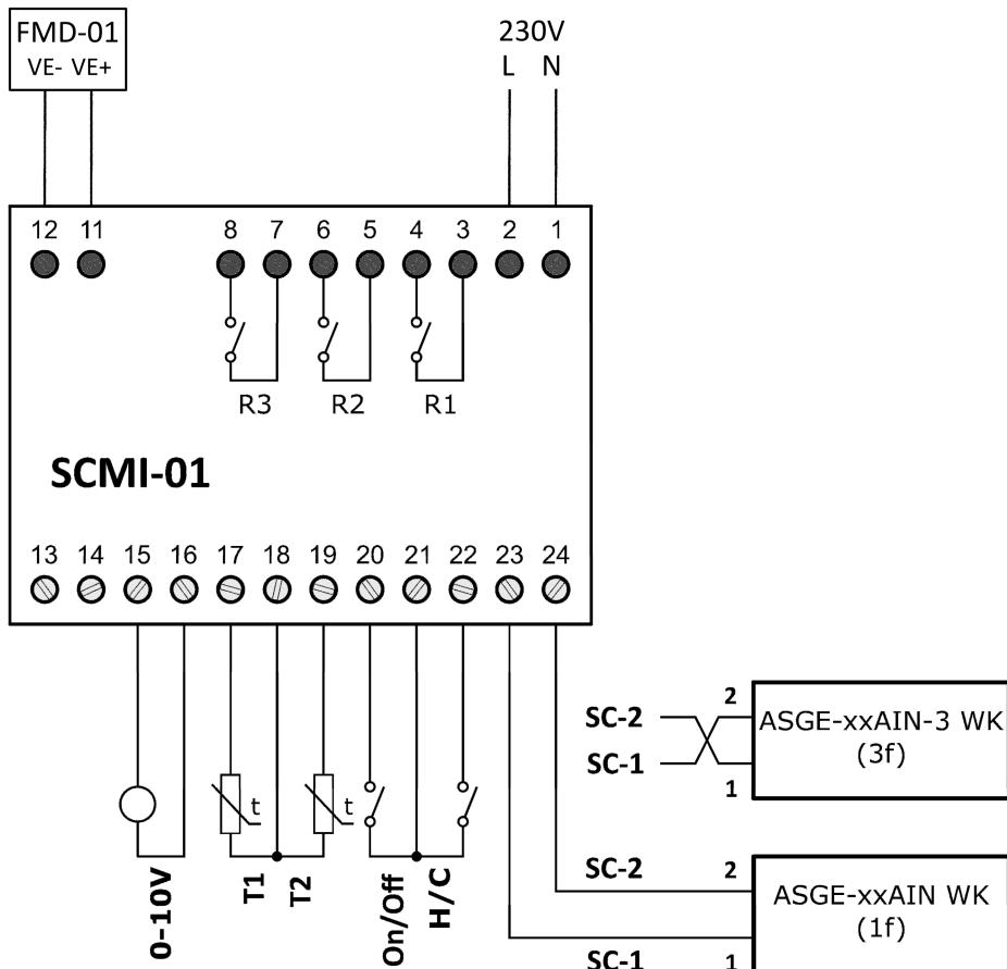
obr. 2. Řídicí modul SCMI-01 v podřízeném režimu
