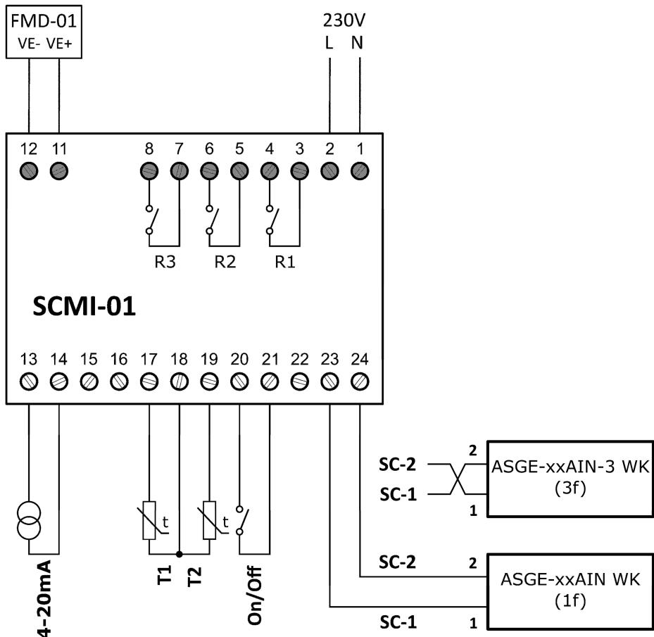
obr. 3. Řídící modul SCMI-01 v režimu autonomního řízení tlaku
