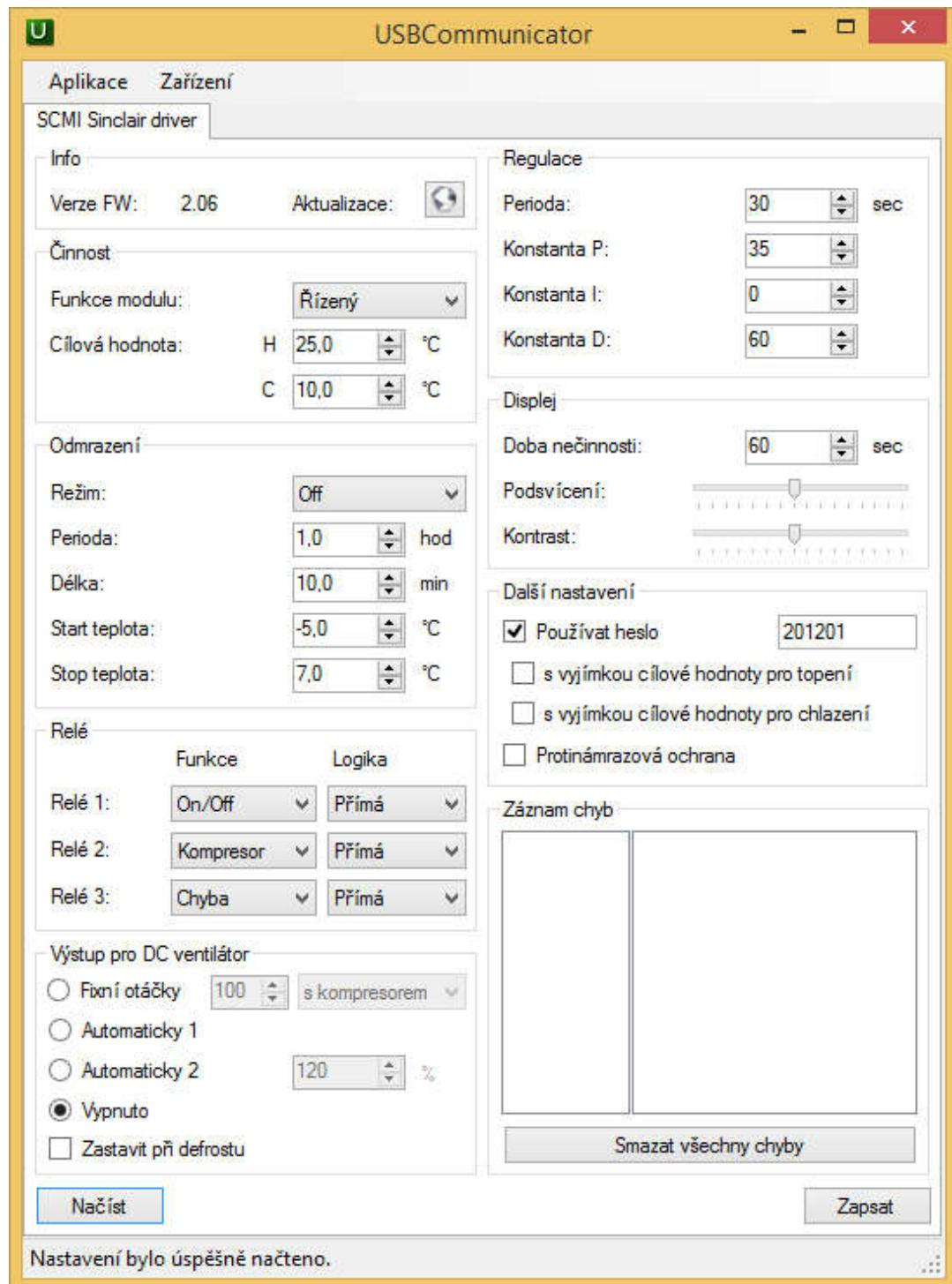
Obr 6. Výchozí nastavení modulu SCMI-01
