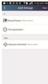
Klepněte na název zařízení, které chcete ovládat. Klepněte na „ON“ (Zapnout) nebo „OFF“ (Vypnout) a pak klepněte na „Save“ abyste dokončili nastavení propojení.
