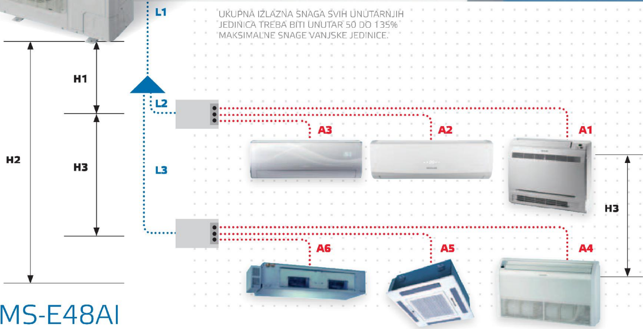
(PRIMJER SPAJANJE NA VANJSKE JEDINICE MS-E48A)
