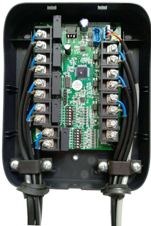
Slika 5.3: Način pričvrščenja kablova.
