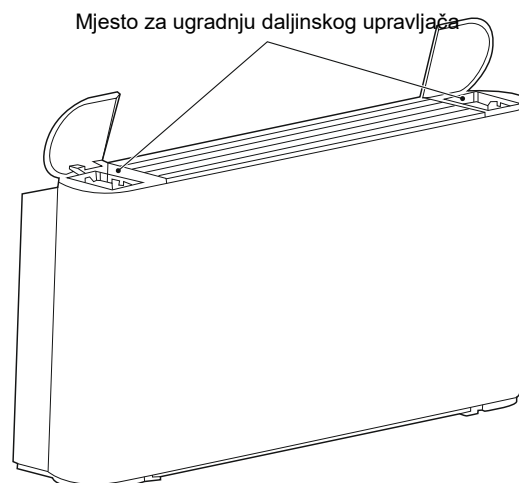
Slika 3-1: Mjesto za ugradnju žičanog daljinskog upravljača
