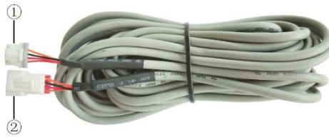
Slika B: Opis prespojnog kabela: Priključite konektor ① u konektor CN2 zidnog daljinskog upravljača; priključite konektor ② u konektor ③ prespojnog kabela
