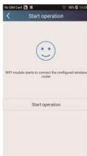
**NAPOMENA:** Nakon završetka konfiguracije nestaje hotspot klima uređaja s kojim je povezan Vaš pametni telefon. Da biste mogli upravljati uređajem na veliku udaljenost, morate se ponovo povezati na kućni Wi-Fi router.
