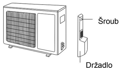
2. Odšroubujte krytku ventilu a nasadte rozšířené hrdlo trubky do přípojky na ventilu.
