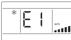
Abb. 6.1: Ansicht bei ausgelöstem Überdruckschutz in der Außeneinheit
