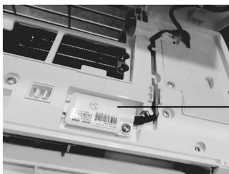
5. Richten Sie das Anschlusskabel für das WiFi-Modul aus, schließen Sie die Abdeckung des Elektrokastens, und ziehen Sie die Schrauben fest.
