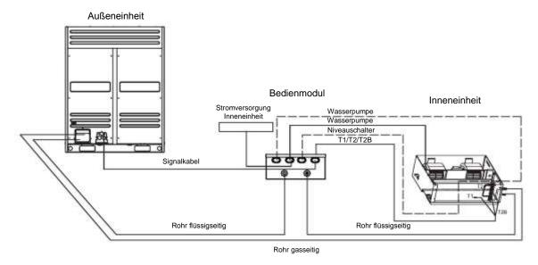
T1 (Lufteinlass) T2 (Mitte Verdampfer) T2B (Ausgang Rohr gasseitig)
