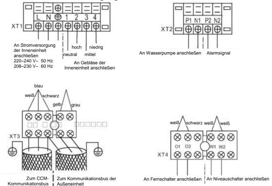
Verwenden Sie ein abgeschirmtes dreiadriges Kabel. Die Abschirmung muss ordnungsgemäß geerdet werden.
