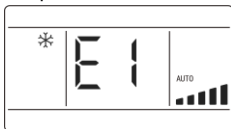
Fig. 6.1: Affichage de la protection activée contre la haute pression de l'unité extérieure
