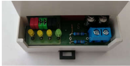
7. ábra: Az átkötő hidak gyári elhelyezése
