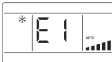
6.1. ábra: A kültéri egységben a magasnyomás-védelem aktiválásának kijelzése
