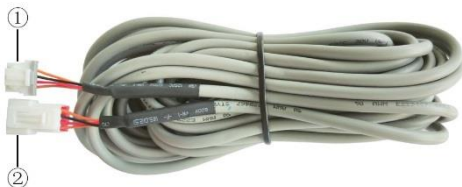
Fig. B: Descrizione del cavo di collegamento: Collegare il connettore ① al connettore CN2 del controller cablato; collegare il connettore ② al connettore ④ del cavo di trasmissione
