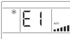
Fig. 6.1: Visualizzazione dell'attivazione della protezione contro l'alta pressione nell'unità esterna
