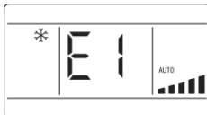
Fig. 6. 1: Visualizzazione dell'attivazione della protezione da alta pressione nell'unità esterna
