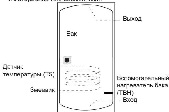
Вспомогательный нагреватель должен быть установлен ниже температурного датчика (T5).
