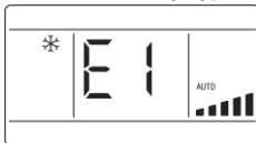
Obr. 6.1: Zobrazenie aktivácie ochrany proti vysokému tlaku vo vonkajšej jednotke
