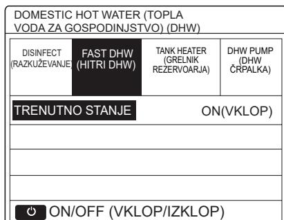
Uporabite "ON/OFF (VKLOP/IZKLOP)" za izbiro ON(VKLOP) ali "OFF(IZKLOP)".
