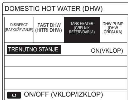
Z "ON/OFF (VKLOP/IZKLOP)" izberite ON(VKLOP) ali OFF(IZKLOP). Uporabite " za izhod.
