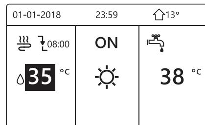
1) Ko je puščica na strani temperature načina delovanja prostora (Vključno z načinom ogrevanja , načinom hlajenja in samodejnim načinom ), pritisnite tipko "ON/OFF (VKLOP/IZKLOP)" za on/off (vklop/izklop) ogrevanja ali hlajenja prostora.
