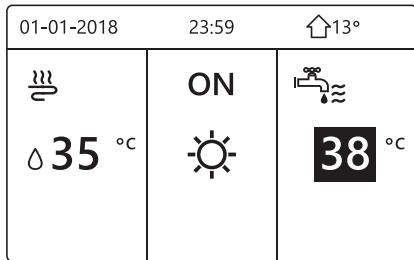
Ko je puščica usmerjena na temperaturo v načinu DHW. Pritisnite tipko ⌂ " za on/off(vklop/izklop) načina DHW.
