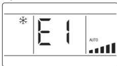
Slika 6.1: Prikaz vklopa zaščite pred visokim pritiskom v zunanji enoti
