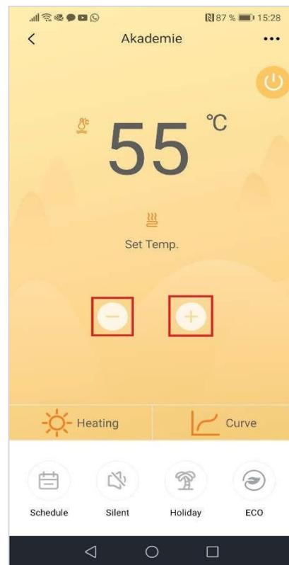
El modo actual se puede configurar usando el botón "Heating" (Calefacción):
