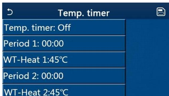
Seleccione “**Period 1**”/“**Period 2**” (Período 1/Período 2); aparecerá una ventana para introducir la duración. A continuación, seleccione “**WT-Heat/WT-Cool 1/2**” (Temperatura del agua de refrigeración/calefacción 1/2); aparece la ventana para indicar la temperatura.
