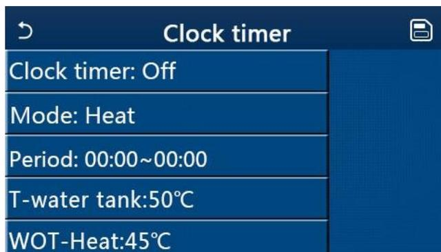
3. La opción “**Mode**” (Modo) se utiliza para configurar el modo requerido; “**WOT-Heat**” (Temperatura del agua de salida para la calefacción) y “**T-water tank**” (Temperatura del agua en el depósito) se utilizan para configurar la temperatura del agua correspondiente; “**Period**” (Período) se utiliza para configurar el período de tiempo. Cuando presione el icono “**Save**” (Guardar) todas las configuraciones se guardarán.
