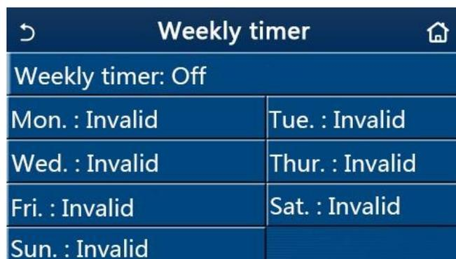
2. En la página de configuración **“Weekly timer”** se puede configurar el temporizador semanal en **“On”** (Encendido) u **“Off”** (Apagado).
