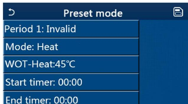
El parámetro **“Mode”** (Modo) se utiliza para preajustar el modo; WOT-Heat (Temperatura del agua de salida para la calefacción) se utiliza para configurar la temperatura del agua de salida fría/caliente; **“Start timer”** (Inicio del temporizador)/**“End timer”** (Finalización del temporizador) se utiliza para configurar la hora. Cuando presione el icono **“Save”** (Guardar) todas las configuraciones se guardarán.
