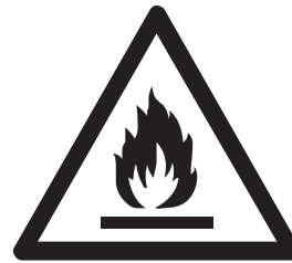
Precaución: riesgo de incendio
